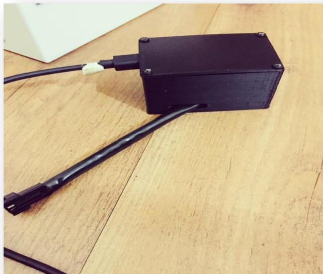
FIGURE-5 LITHIUM ION BATTERY VOLTMETER MONITORING MICRO CONTROLLER DEVICE
